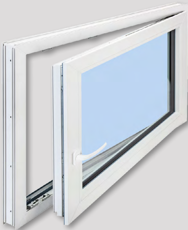
MEALON Dreh-Kipp Komfort: 5-Kammer-Profil (70 mm Rahmenstärke), Wärmeschutzglas, U_g = 1,1 \text{ W/m}^2 \text{ K} ( U_w = 1,3 \text{ W/m}^2 \text{ K} )
