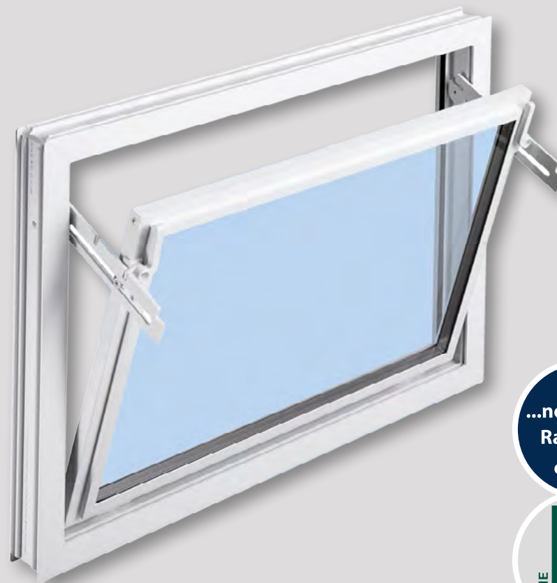
MEALON Kipp-Fenster: wahlweise mit Isolierverglasung 14 mm ( U_g = 3,3 \text{ W/m}^2 \text{ K} ) bzw. 24 mm ( U_g = 3,0 \text{ W/m}^2 \text{ K} ) oder Einfachverglasung ( U_g = 5,6 \text{ W/m}^2 \text{ K} )
